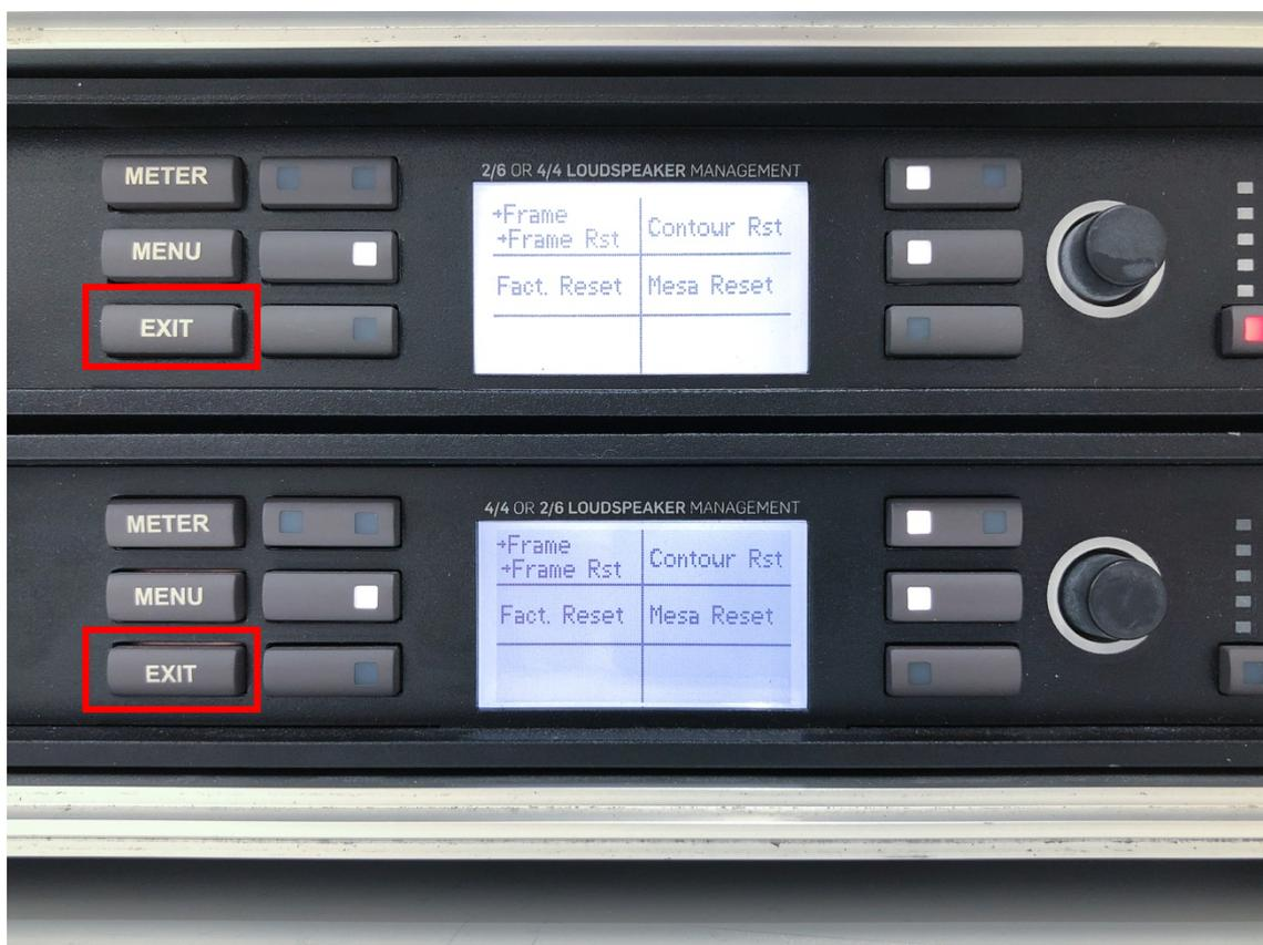
3 Contour Mode とは2チャンネルのインプット EQ (Raised Cosine Filter) が利用でき 6チャンネルのアウトプット EQ が利用できるモデルで LM26 のデフォルトです。3 Way x 2 から 6 Way x 1 まで自由度の高い組み合わせができるのが特徴
