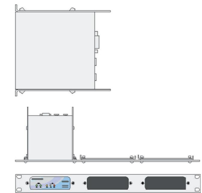
Si noti che i fori alle estremità posteriori delle staffe possono essere utilizzati come punti di fissaggio del cavo, se lo si desidera.
