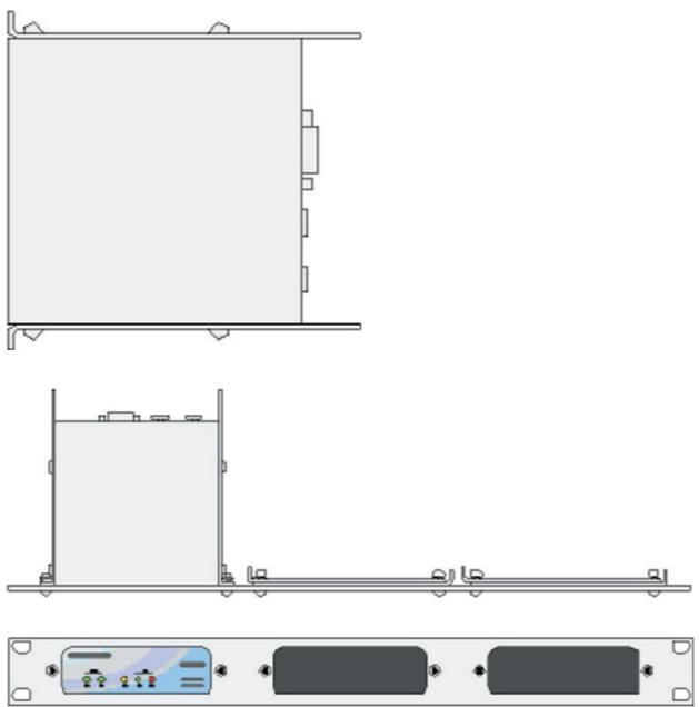
Beachten Sie, dass die Löcher an den hinteren Enden der Halterungen auf Wunsch als Kabelbindungspunkte verwendet werden können.
