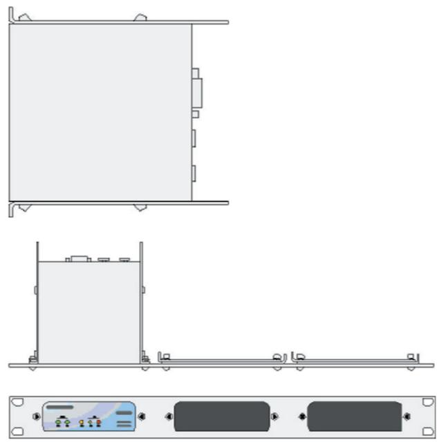
Observera att hålen i fästenas bakre ändar kan användas som kabelanslutningspunkter om så önskas.
