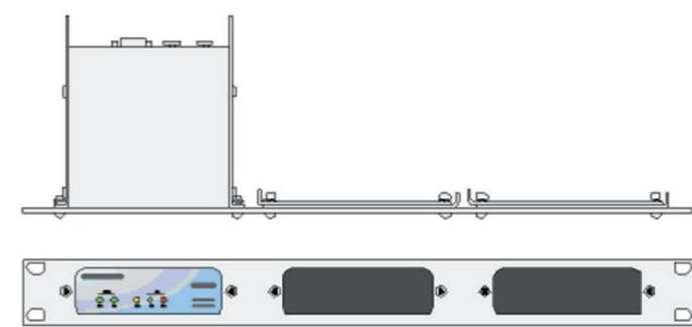
Observe que os orifícios nas extremidades traseiras dos suportes podem ser usados como pontos de amarração de cabos, se desejado.
