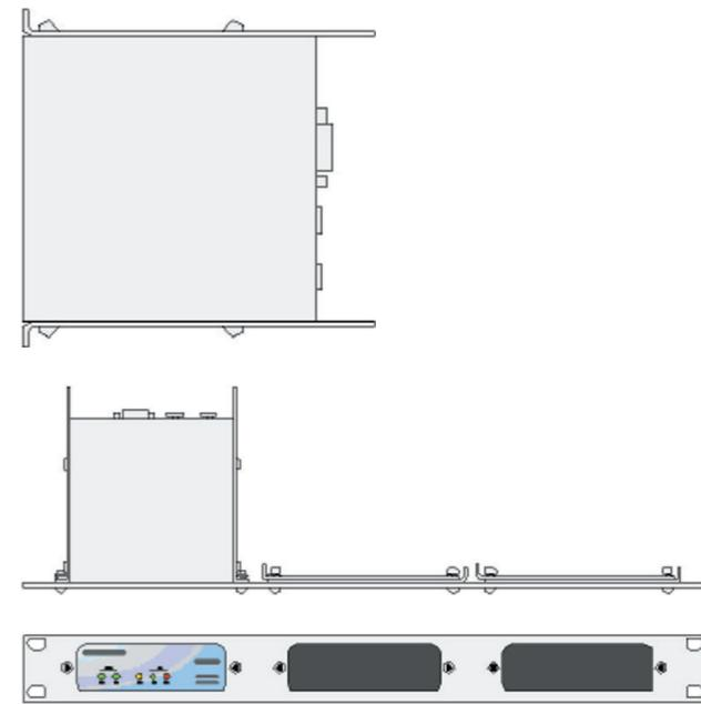
Notez que les trous aux extrémités arrière des supports peuvent être utilisés comme points d'attache de câble si vous le souhaitez.
