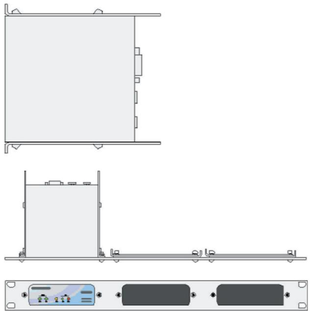
Tenga en cuenta que los orificios en los extremos posteriores de los soportes se pueden usar como puntos de amarre de cables si lo desea.
