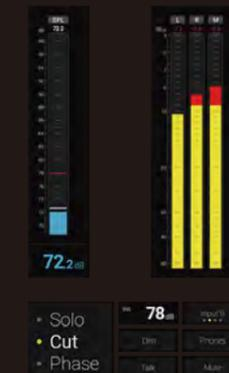
SPL メーターには室内の音圧レベルが表示されます。これはエンジニアの聴力を保護するための重要な指針となるものです。SPL は棒グラフまたは数値またはその両方で表示できます。ダウンミックスインストゥルメントは、サラウンドまたはイマーシブ ミックスをステレオおよびモノラルで出力します。ダウンミックスされた信号はスピーカーまたはヘッドフォンでモニターしたり、オーディオネットワーク内の任意の送信先に送信可能です。各スピーカーのミュート、ソロ、位相反転の操作が簡単に行え、トークバック機能では、スピーカーまたは Dante® ネットワーク内の任意の送信先と会話できます。LF Boost で LFE チャンネルの 10 dB ブースト Surr. Att. ではサラウンド チャンネルを 3dB 減衰できます。
