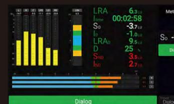
ダイアログ ゲート 測定をサポートにより Netflix 等の配信標準に準拠するダイアログ ベースの仕様に準拠。ラウドネスナンバー インストゥルメントは、ID (ダイアログベースインテグレートッド)、SD (ダイアログベースショートターム)、D (ダイアログコンテンツパーセンテージ) などの指標を数値表示可能。LRA インストゥルメントはダイアログ ゲート ラウドネス範囲を表示し、ダイアログインストゥルメントはダイアログが存在するかどうかを識別。このインストゥルメントは、小さなオーバーレイから画面全体をカバーするまで、サイズを変更可能。さらに、ダイアログを含むチャンネルはユーザー設定可能。
