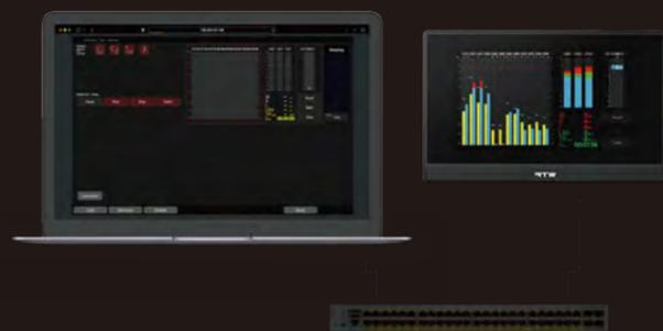
ブラウザのインターフェイスで全体的な設定の編集、プリセット管理ができます。さらに、デバイスへのアクセスを制御し、特定の機能の制限によりライブパフォーマンス中に誤った使用をされないようにすることもできます。
