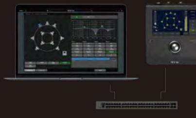
ブラウザーのインターフェイスで全体的な設定の編集、プリセット管理ができます。さらに、デバイスへのアクセスを制御し、特定の機能の制限によりライブパフォーマンス中に誤った使用をされないようにすることもできます。
