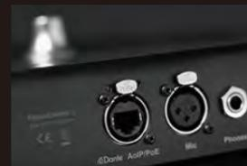
TouchControl 5 は Dante® Audio over IP ネットワーク用に設計されています。96 kHz までの最大 32 チャンネルの入力と出力をサポートします。(AES67 モードでは 48kHz)
