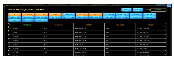
この画面を表示するには、All タブのコントロールバー Global Event & Control(F9) > Control タブの右下にある Global IP Configuration から、または Module(F3) > I/O Config & Worksheet(F4) > Technical Data(F5)に表示されている Global Overview より表示することができます。
