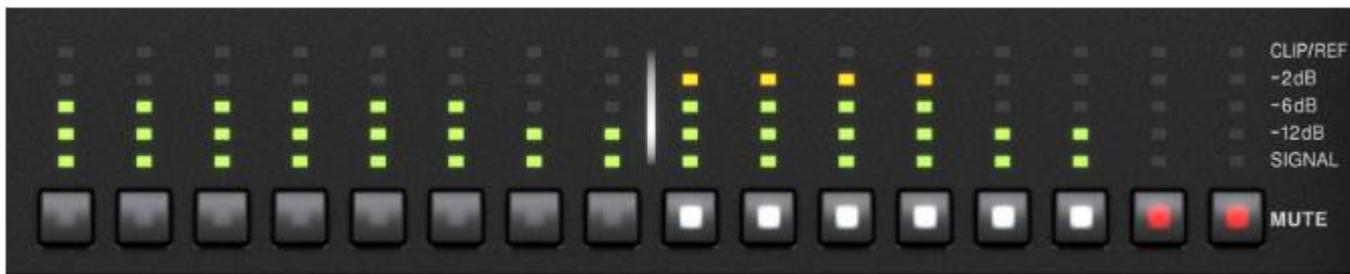
図6-3ではAとBと書かれたボタンがモジュールインプットのミュートを行い、1-6と書かれたボタンはモジュールアウトプットのミュートを行います。ボタンのLEDは、モジュールのインプットまたはアウトプットがミュート(赤)、ミュート解除(白)、未使用(点灯しない)のいずれであるかを表示します。モジュールインプットミュートはContourモードでのみ有効で、Mesaモードでは適用されません。アウトプットのミュートボタンの数と位置はボタンの数と位置は、図6-3に示すように、デバイスがContourモード(最大12出力)かMesaモード(8出力)かで変わります。ミュート状態は、ディスプレイにも赤で表示されます。ソフトウェアによるモジュールのミュートコントロールの詳細については、『Lake Controller Operation Manual』を参照してください。
