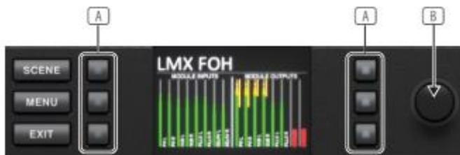
図:6-2マルチファンクションボタン、コントロール、LED付きLCD
