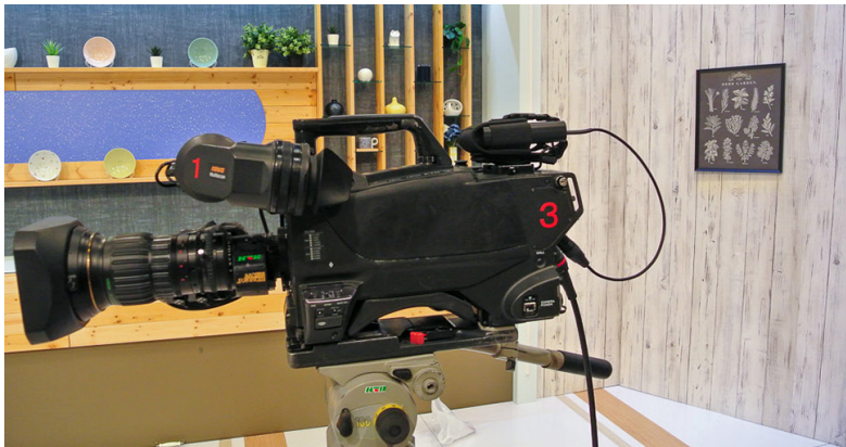
BP750をマスターベルトバックモードで動作させV-マウントアダプタを装着したポーチにてカメラへ取り付け
