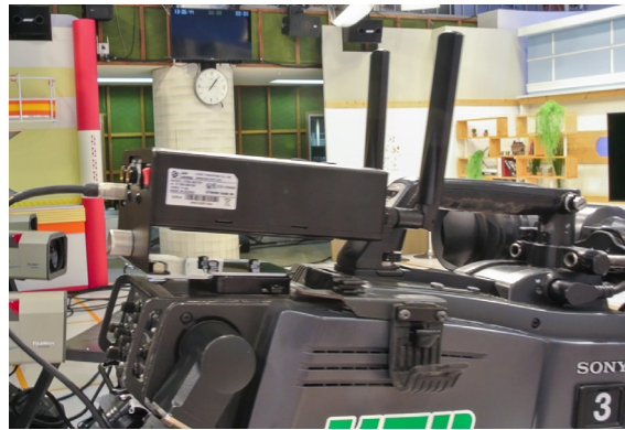
MS150にVマウントアダプタを装着し、カメララインカム端子とオプションケーブル1本で接続
