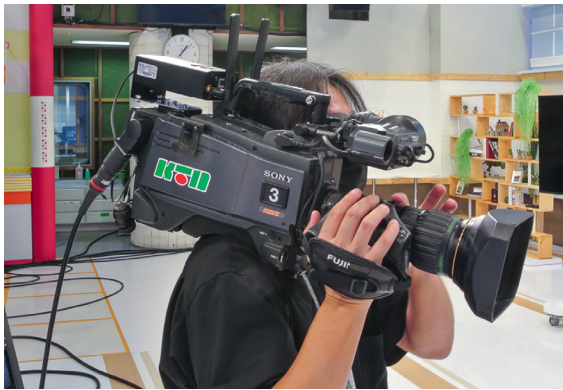
MS150にVマウントアダプタを装着し、カメララインカム端子とオプションケーブル1本で接続
