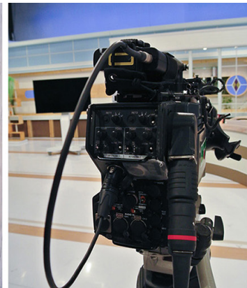
BP750をマスターベルトバックモードで動作させV-マウントアダプタを装着したポーチにてカメラへ取り付け
