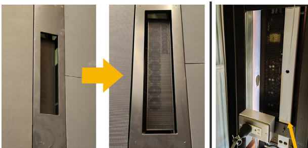
QFLEXの取付。LEDビジョンのフレームに開いた窓へ裏側から入れている最中の様子。
