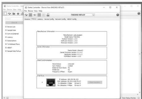
8. Dante ネットワーク同期の詳細については、デフォルトのルーティングビューから Clock Status タブに移動してください。このビューには、ネットワーク内のデバイスの内部クロックが同期されているかどうかが表示され、FAD シリーズの Master/Slave 状態も表示されます。デバイスの Master/Slave 状態は、本体の背面パネルにも表示されます。CLOCK SYNC LED が連続して緑色で点灯している場合はネットワーク内の別のユニットに対してスレープであることを示し、緑色で点滅している場合は FAD ユニットがネットワークのマスターであることを示します。
