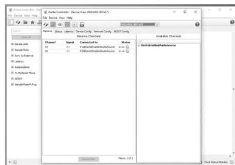
6. Device Config タブでは FAD シリーズのオーディオ設定の変更が行えます。オーディオエンコーディング（サンプルレート、ビットデプスなど）は、オーディオソースデバイスの設定に合わせる必要があります。一致しないとシグナルチェーンが切断され、再び一致するまでサブスクリプションが保留されます。
