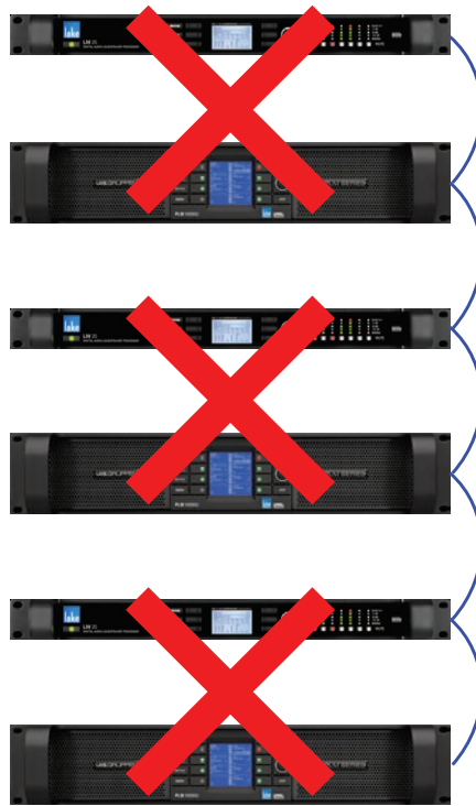
図 3-16: Dante 使用時には 2 台以上の Lake デバイスをデジーチェーン接続しないでください
